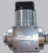
Kegelradgetriebe für Servo-Applikationen und als reines Verteilgetriebe, 12 - 3200 Nm, i von 1:1 bis 500:1, \leq 6 arc min
